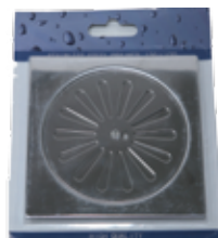
Σχάρες INOX B.T. Περιστρέφοντας την, κλείνει, για αποφυγή ανόδου αφρών & οσμών.
