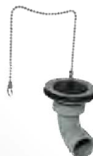
Βαλβίδα Ντουζιέρας Ορειχάλκινη 1 1/2" με πλαστική γωνία και παξιμάδι
