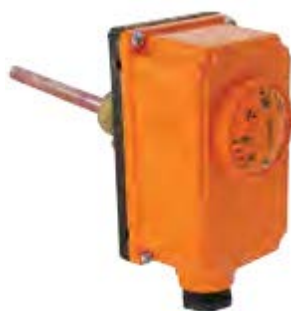
TC-2 542470 Θερμοστάτης Εμβαπίσεως 0-90°C 1/2" L=100mm
